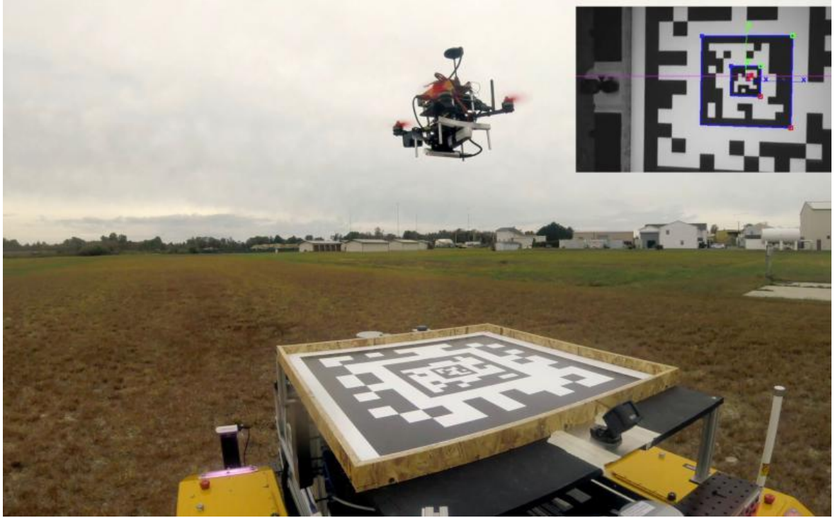
Küçük bir insansız hava aracı (İHA), bir Warthog insansız kara aracına yaklaşarak üzerinde markalanmış alana iner. ARL'nin Graces Quarters'daki yeni robotik testi, arařtırmacıların saha koşullarında karmaşık robotik etkileşimlerle deney yapmasına olanak tanıyabilmektedir. (Fotoğraf: ABD Kara Kuvvetleri)
